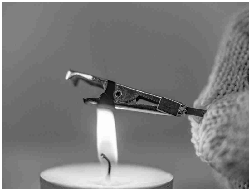
Рис. 1. Схема установки для измерения температуры Кюри неодимового магнита.
