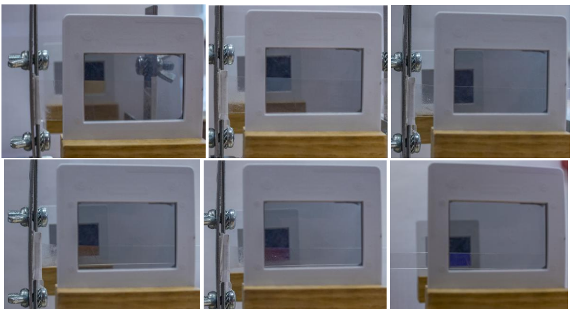
Рис. 2. Наблюдение глазом скотча между скрещенными поляризаторами при последовательном растяжении.
