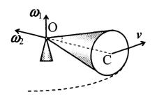
вертикальной неподвижной оси с угловой скоростью  $\vec{\omega}_1$  и вращении вокруг оси OC с угловой скоростью  $\vec{\omega}_{2}$ . Направление соответствующих векторов показано на рисунке. При этом точка С движется ПО окружности радиуса  $R/tg\alpha$ с постоянной скоростью u, поэтому  $\omega_1 = vtg\alpha/R$ .
