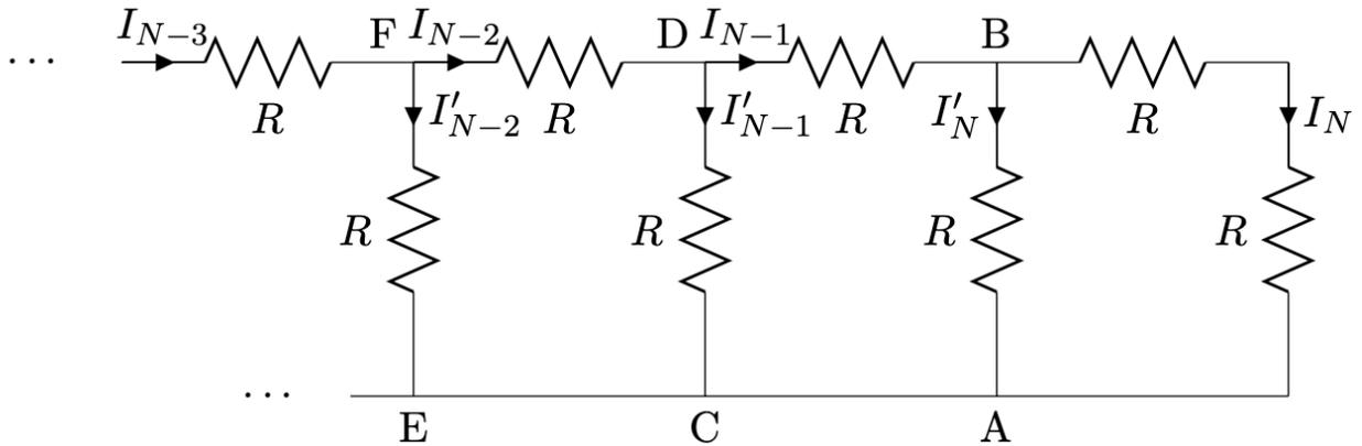
Падение напряжения на  $AB = 2RI_N = I'_N R \Rightarrow I'_N = 2I_N$  и  $I_{N-1} = 3I_N$ .
