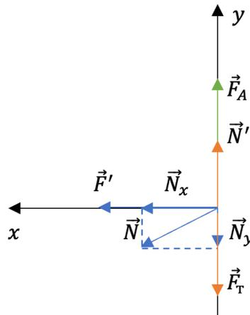
$\vec{F}'$  и  $\vec{F}'_A$  - две проекции результирующей силы давления со стороны воды на шар,  $\vec{N}$  - реакция стенки сосуда на шар,  $\vec{F}'_T$  - сила тяжести шара,  $\vec{N}'$  - сила реакции дна сосуда на шар. Так как сосуд движется с ускорением  $\vec{a}$ , сила  $\vec{F}' = \rho V \vec{a}$ , сила  $\vec{F}'_A = \rho_0 V \vec{g}$ .
