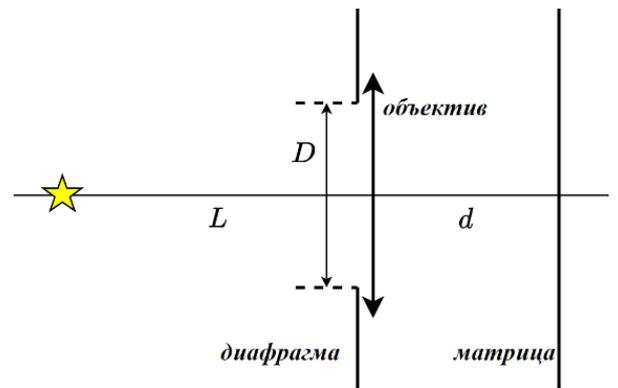
Фотокамера фиксирует изображение точечного источника света. Оказалось, при фотографировании предмета, находящегося на расстоянии  $L_0 = 30$  см от объектива, формируется резкое изображение на матрице.
