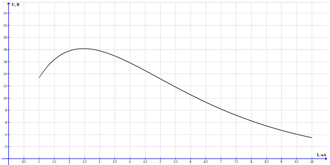
3.1 Какой ток течёт в цепи при последовательном включении НЭ с резистором  $R = 2 \text{ кОм}$  к источнику тока с ЭДС  $\mathcal{E} = 20 \text{ В}$ ?
