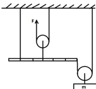
Начнем с рассуждений о влиянии двух подвижных блоков на систему. Блок, к которому приложена сила  $F$ , дает выигрыш в силе в два раза, тем самым на рычаг действует сила  $2F$ . (1)
