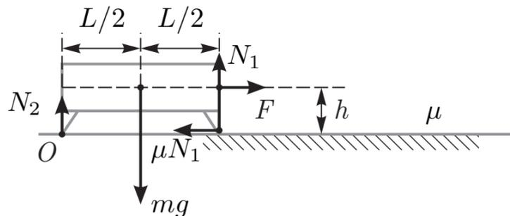
Для этого запишем правило моментов относительно точки  $O$  из сопутствующей инерциальной системой отсчетов, в которой скамья покоится:
