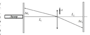
отраженный луч должен находиться приблизительно на высоте выходящего луча и хорошо виден на экране. Вы можете видеть два отражения, самостоятельно определите, какой из них отразился от передней грани линзы. Желательно, чтобы луч, отраженный от центра линзы, после отражения попадал примерно в точку его выхода из экрана (в нем есть отверстие для луча). За линзой на расстоянии 45-50 см за линзой расположите экран на подставке. На нем вы должны видеть преломленный луч. Линзу можно смещать
