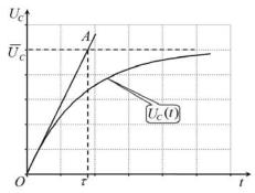
конденсаторе растет пропорционально времени (прямая OA на рисунке). Время достижения предельного напряжения на конденсаторе, при таком линейном росте и является характерным временем зарядки  $\tau$  .
