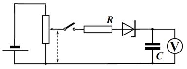
**4.3** Измерьте зависимость напряжении на конденсаторе от времени при значениях напряжении  $U_0$  равному 4,0 В. Постройте график полученной зависимости.
