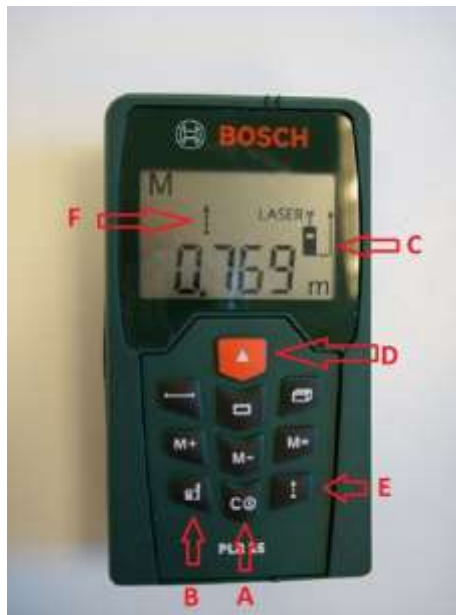
Рисунок 1.2 Вид спереди лазерного дальномера. Не обозначенные шесть кнопок в измерениях не используются (они используются для вычисления площади и объема).
