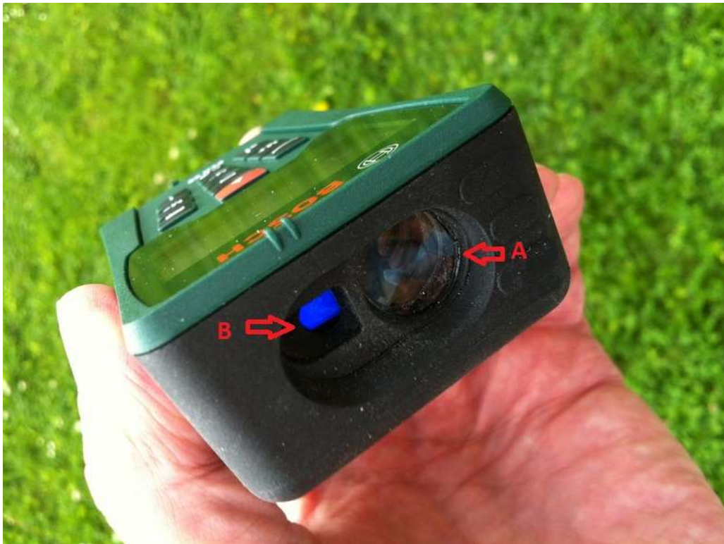
Рисунок 1.3 Лазерный дальномер, вид с переднего торца:
