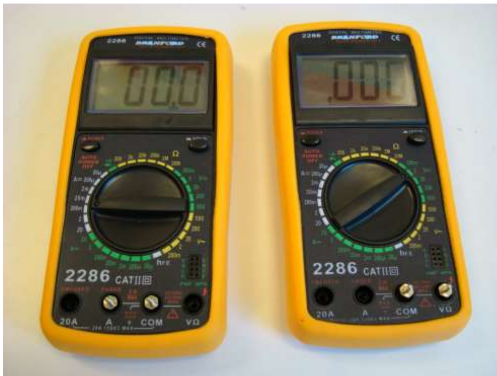
Рисунок 2.3 Мультиметры, оборудованные специальными выводами для использования в качестве амперметра (слева) и вольтметра (справа). Мультиметры включаются нажатием кнопки “POWER” в левом верхнем углу. По истечении некоторого времени Мультиметр автоматически выключается, если он не используется. Он может измерять как постоянный ток и напряжение ( = ), так и переменный ток и напряжение ( \sim ). Внутреннее сопротивление вольтметра 10 МОм независимо от измеряемого диапазона. Падение напряжения на амперметре составляет 200 мВ независимо от измеряемого диапазона. В случае
