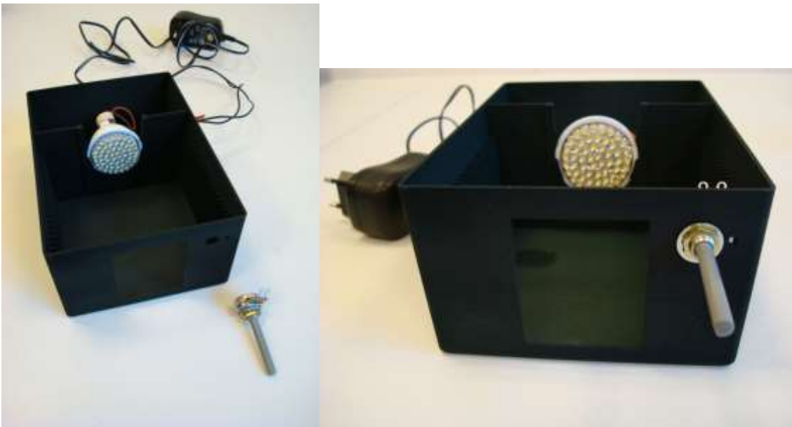
Рисунок 2.2 (а) Черная коробка с источником света и переменный резистор (б) Переменный резистор, закрепленный в черной коробке. Обратите внимание, что на нижней стороне переменного резистора имеется специальный выступ, который нужно вставить в отверстие коробки справа от рукоятки и прикрутить его гайкой с шайбой.
