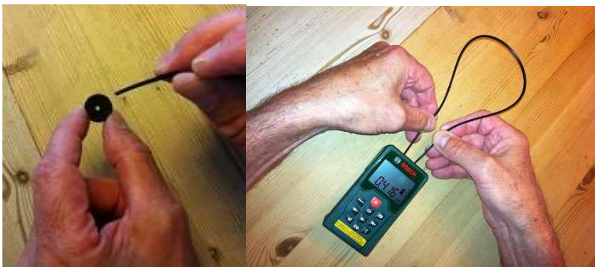
Рисунок 1.5 (а) Войлочная прокладка и оптоволокно. (б) Присоединение оптического волокна.
