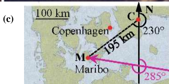
Рисунок 1.1 Азимут – это угол, между направлением на север и направлением на тело от камеры наблюдения, отсчитываемый по часовой стрелке. Высота – угол между направлением на тело от камеры наблюдения и горизонтом. (a) Серия снимков, сделанных камерой наблюдения в Швеции, показывает полет метеорита Марибо (огненный шар) в атмосфере. (b) Данные с двух кадров, снятых камерой С, указывающие время, азимут и высоту над горизонтом. (c) Эскиз, показывающий траекторию Марибо (малиновая стрела) и место падения (М) в Дании, как было видно камерой (С) из Швеции.
