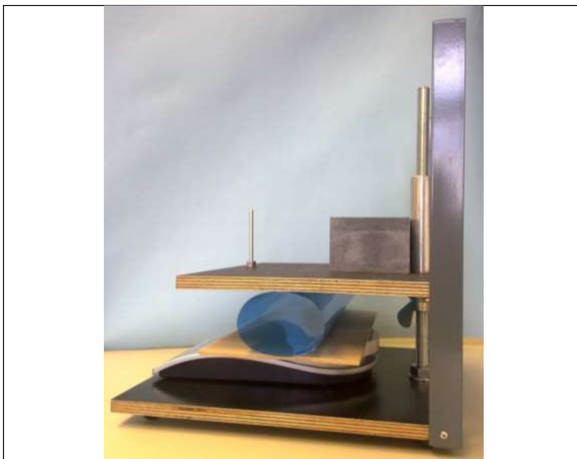
Рис. 3. Фотография установки для измерения сопротивления изгибу.
