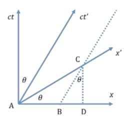
Стержень представлен на диаграмме отрезком АС. Так как длина стержня в подвижной системе отсчета S' равна L, то в соответствии с вышесказанным на диаграмме он изображается отрезком АС длинной  $\sqrt{\frac{1+\beta^2}{1-\beta^2}}L$ . Длина стержня в лабораторной системе отсчета S определяется на диаграмме построением отрезка AB.
