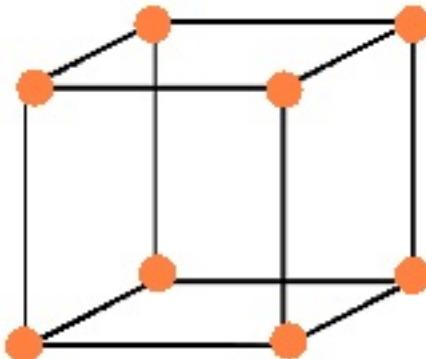
1. Элемент **X** существует в виде кристаллов с простой кубической решеткой. Его плотность  $\rho$  составляет **9.14 г/см<sup>3</sup>**. С помощью кристаллографии, было определено что длина ребра куба  $a$  составляет **3.36 Å** ( $1 \text{ Å} = 10^{-8} \text{ см}$ ). С помощью рассмотрения элементарной ячейки, можно понять что молярную массу **X** можно определить используя следующее уравнение:
