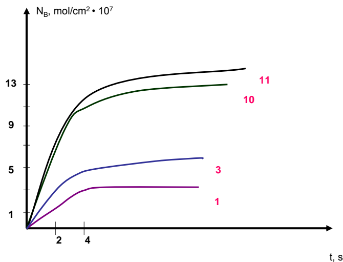
Рисунок 1б. Зависимость количества продукта, N_B , от времени
