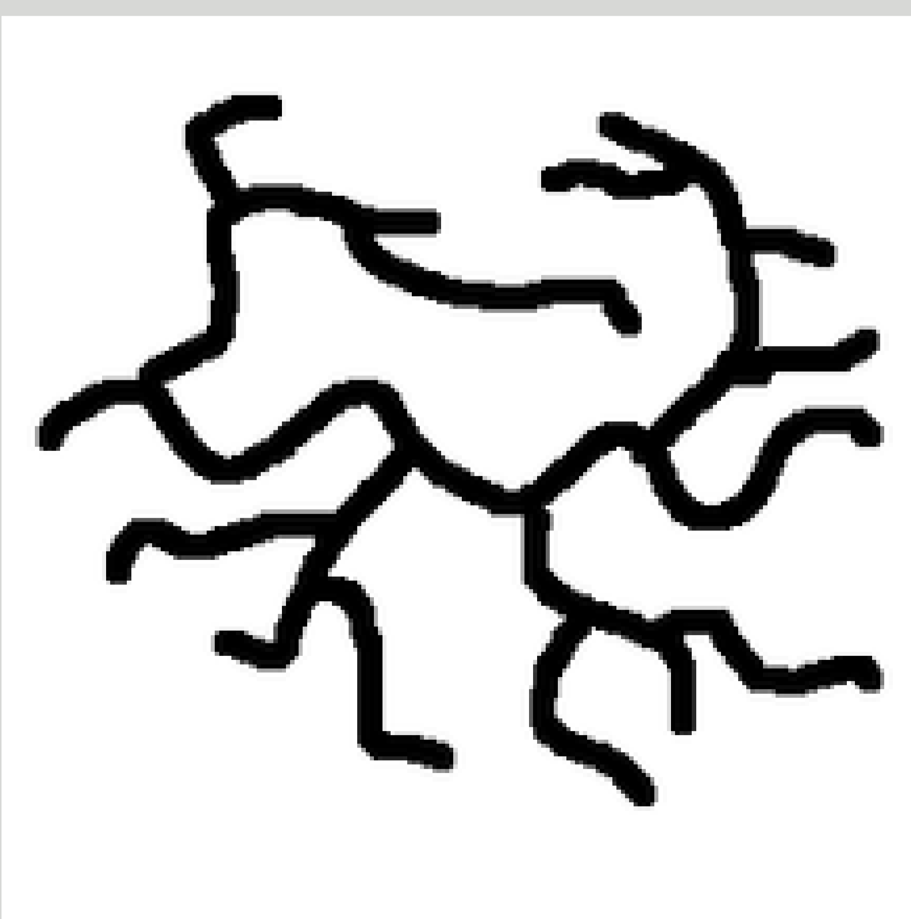
Очень схематичное изображение молекулы LDPE. Каждая линия – это множество фрагментов -\text{CH}_2\text{CH}_2-
