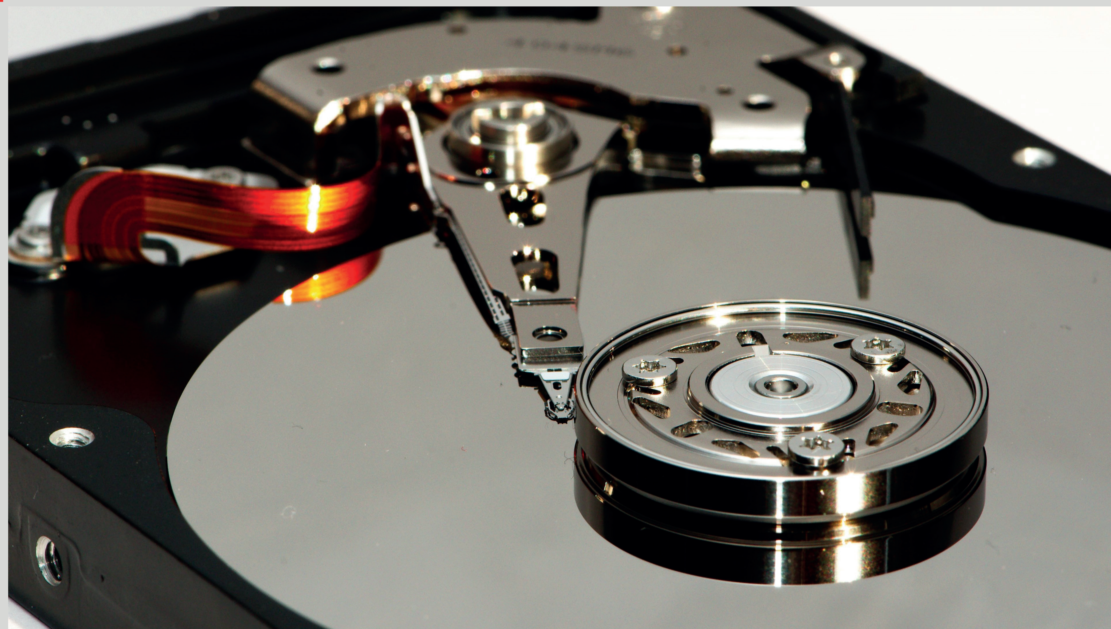
Круглая пластина с ферронапылением и считывающая игла. Строение винчестера
