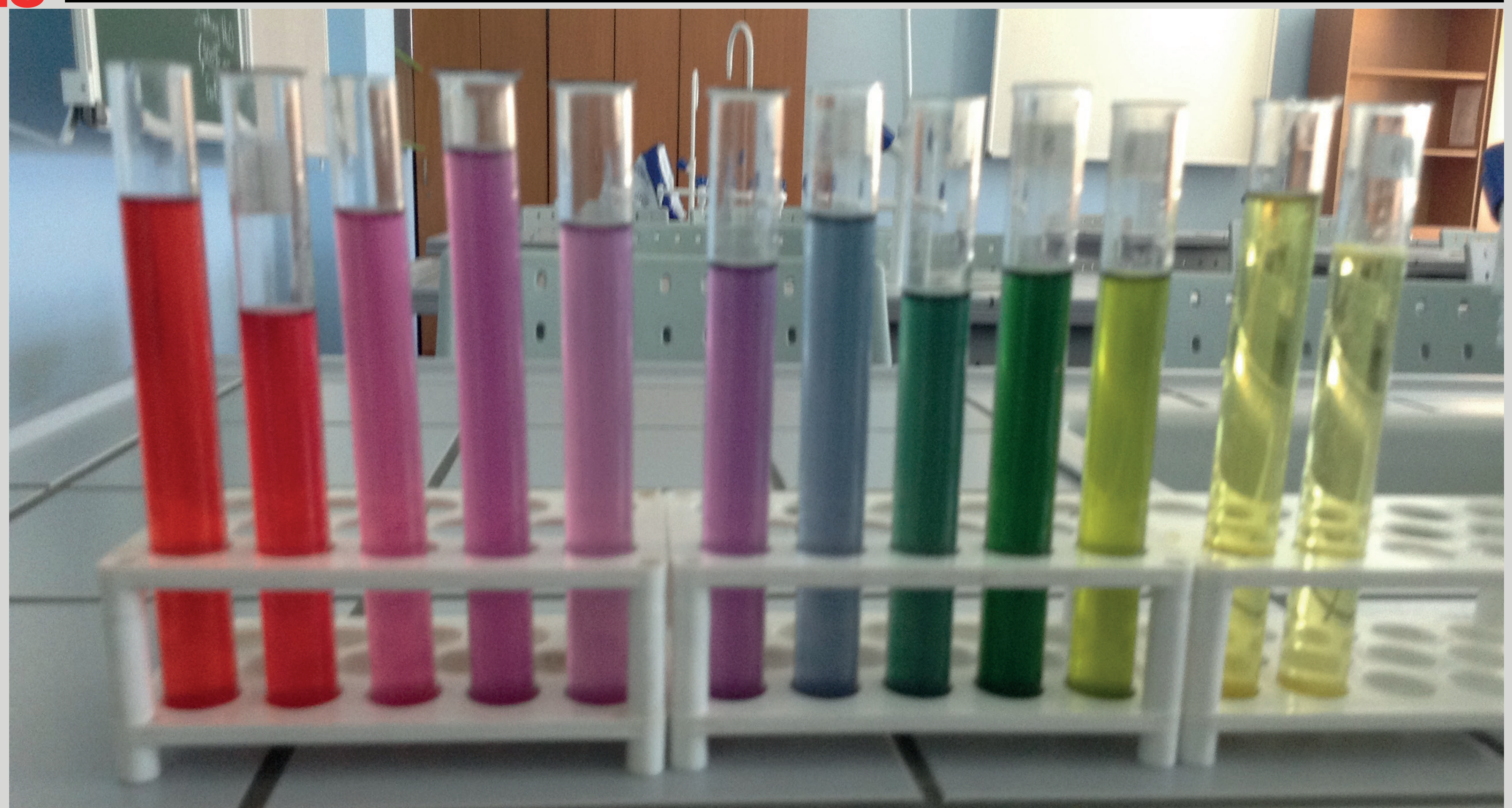
Сок краснокочанной капусты в растворах с разной кислотностью среды. Слева направо: pH 1–2–3–4–5–6–7–8–9–10–11–12
